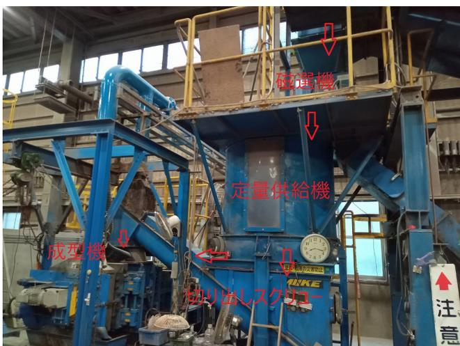
再度磁選機を通過後、定量供給機で攪拌後に切り出しスクローで成型機へ、100度～130度の熱で成形されます。
