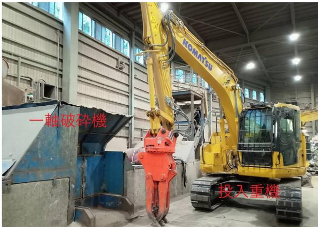
RPF の原料を重機で混ぜながら一軸破碎機に投入します。
