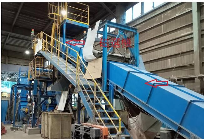
破碎された材料はコンベアで成型機に運ばれます。途中で磁選機による金属除去が行われます。
